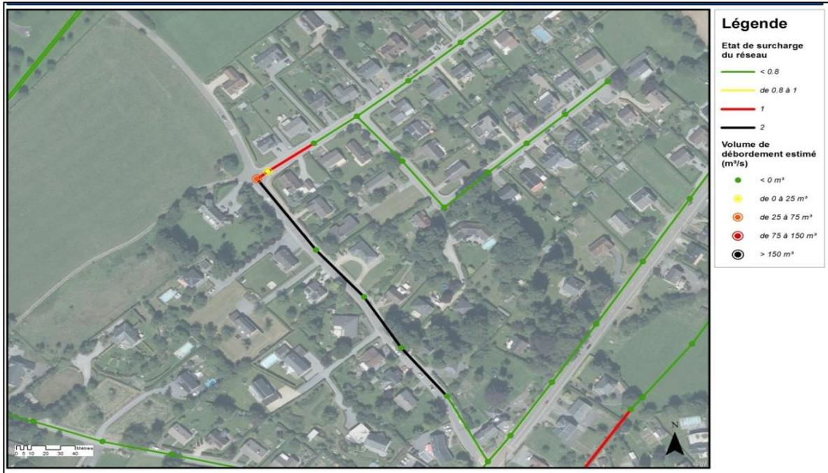
Figure 2. Mise en évidence, par la modélisation, de tronçons d'égout saturés © INASEP
