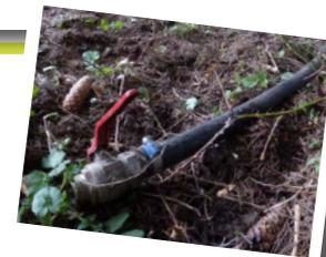
Étape 6 : remplir le socarex d'eau pour amorcer le système et placer la crépine au niveau d'un secteur du cours d'eau profond et caillouteux. Pour ce faire, créer éventuellement un seuil
