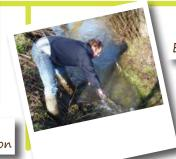
Étape 4 : placer la crépine au niveau d'un secteur du cours d'eau rapide, profond et sans vase. Actionner la pompe jusqu'à ce que l'eau jaillisse dans le bol en veillant à ce qu'il n'y ait pas d'entrée d'air
